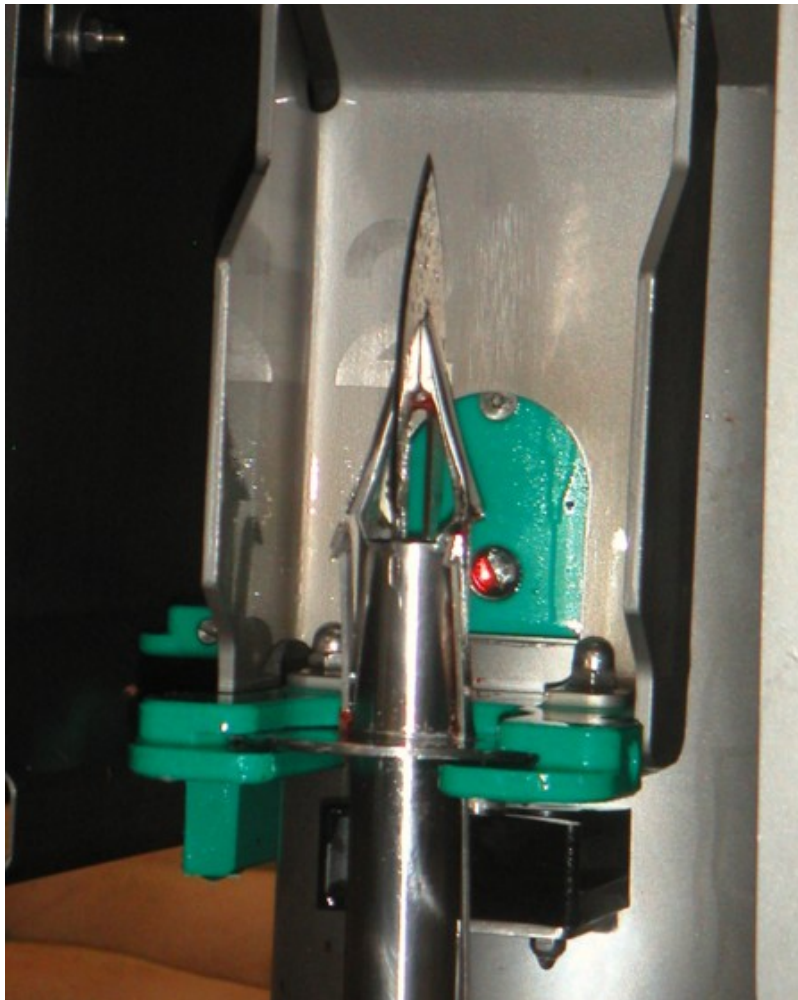
Slika 8-14 Šuplji nož za iskrvarivanje
